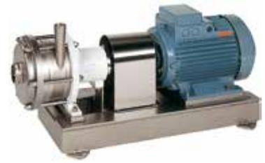
Y a diferencia de otras bombas multi-etapa, es limpiable in situ (CIP). El rodete es abierto o semi abierto eliminando cualquier recoveco susceptible de no ser limpiado. La bomba multi-etapa W+ está equipada con un cojinete de alta resistencia que absorbe las fuerzas radiales y axiales presentes en este tipo de bombas. Puede, por ello, usar motores estándar.
