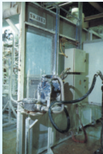
Esta bomba Blagdon 50 metálica en Caradon Bathroom alimenta un robot en una operación de esmaltado por pulverización.
