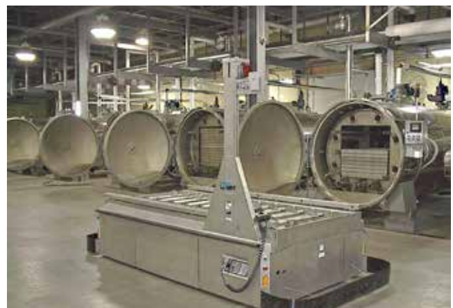
Sistema de transporte con AGV (vehículo de guiado automático)
