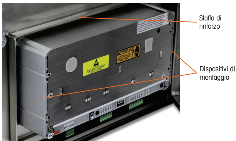
Figura 2-6: Staffa di rinforzo per pannello installata
