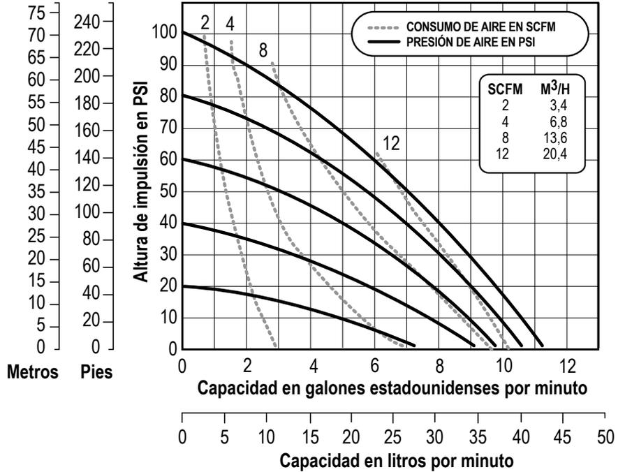
NOTA: el rendimiento se basa en lo siguiente: bomba ajustada a PTFE, succión de inundación, agua en condiciones ambientales. La utilización de las condiciones hidráulicas variantes y otros materiales puede dar lugar a una desviación en exceso de un 5 %.
