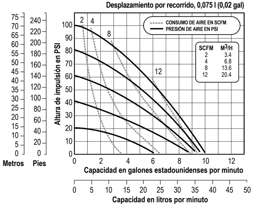
NOTA: el rendimiento se basa en lo siguiente: bomba ajustada a PTFE, succión de inundación, agua en condiciones ambientales. La utilización de las condiciones hidráulicas variantes y otros materiales puede dar lugar a una desviación en exceso de un 5 %.
