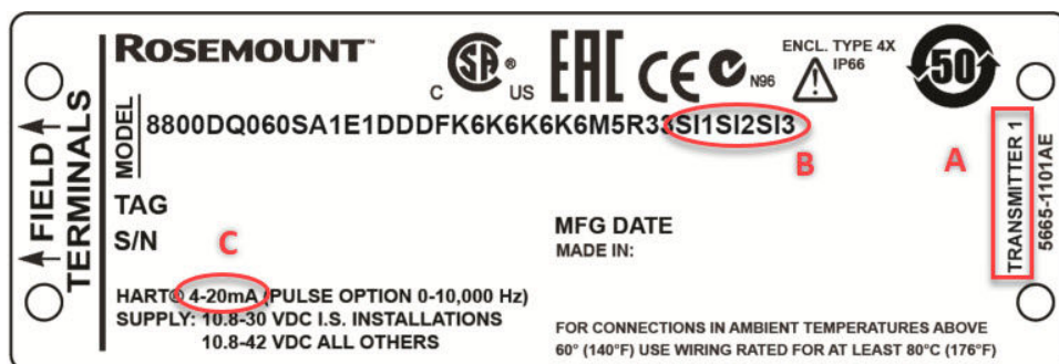
Figura 2-2: Ejemplo de placa de identificación de transmisor cuádruple
